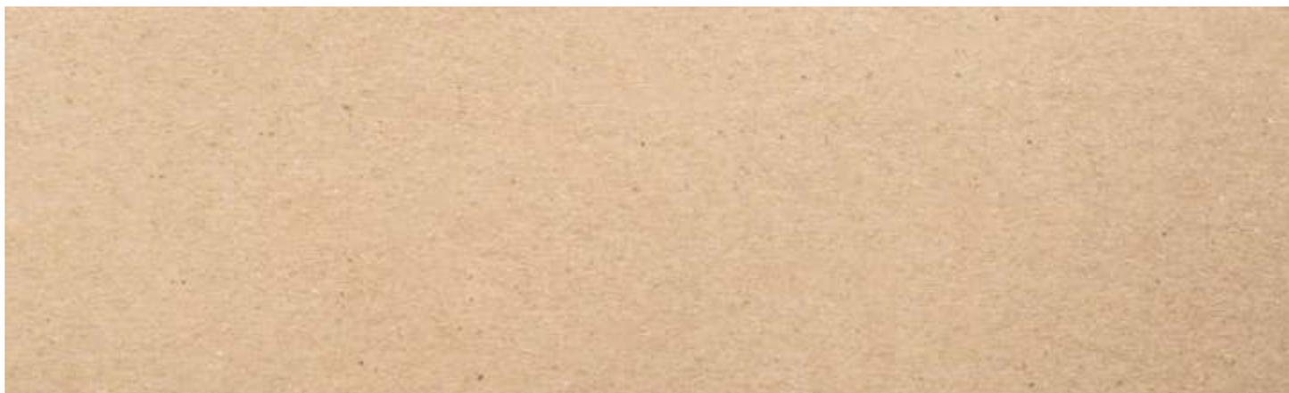
ДВП средней плотности сухого непрерывного способа производства марок ТСН-35 и ТСН-40 по ТУ-5536-005-93222532-2015. Запуск производства ДВП на Вятском фанерном комбинате состоялся в 2003 году. Предприятие укомплектовано немецким оборудованием фирмы BISON, технологический уровень которого позволяет выпускать ДВП высокого качества. ДВП Вятского фанерного комбината применяется для производства дверей и стеновых панелей, в строительстве, для производства погонажных изделий и мебели.
