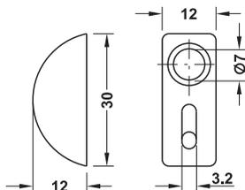
Отверстие в стеклянной полке:  $\varnothing 9,5$  мм, учитывайте данные фирмы-изготовителя стекла для расстояния между отверстиями.
