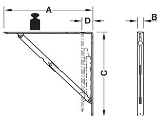
> Несущая способность: На штуку, проверено по стандарту DIN EN 16337:2013-08 с дробильной плитой 1,7 кг, то есть, удвоенная несущая способность при поверхностной нагрузке и 2 кронштейнах, размер полки соответственно согласован с глубиной консоли
