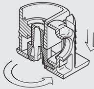
За счет затягивания зажимного элемента во врезной части полка блокируется, а несущая часть и врезная часть плотно соединяются друг с другом.
