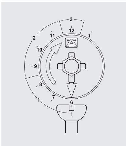
Часы Minifix® поясняют путь затягивания А, который подразделяется на **3 диапазона пути** с различными функциями:
