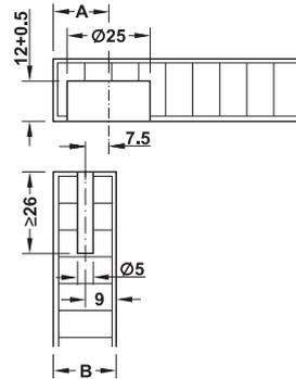
Размер А = размер отверстий для сверления
