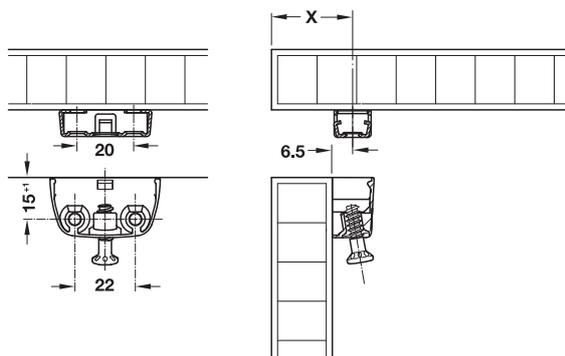
Размер X = толщина детали + 6,5 мм
