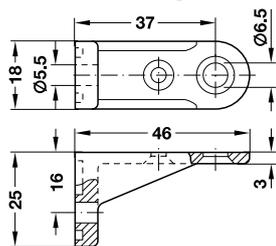
> Возможна дополнительная фиксация шурупом для ДСП диаметром 3,5 мм
