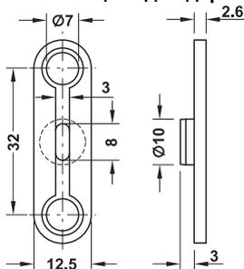
Крепление 2 евровинтами 6,3 x 13 мм, дополнительно глухое отверстие:  $q 10$  мм
