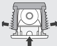
При вдавливании опорной части во всверливаемую деталь последняя распределяется в полке (нагрузка рычага до 25 кг). Опорная часть крепится во всверливаемой детали с помощью пружины.
