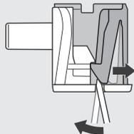
Тонкий металлический штифт (Ø 1,0–1,4 мм, например, игла) может быть использован для деблокировки стяжки и легкого извлечения полки.
