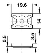
> Область применения: Для соединения двух задних стенок со средним щитом
