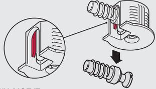
Конструкционные полки могут вставляться **только сверху** (вертикальный монтаж или монтаж сверху) за счет этого детали предварительно зафиксированы.
