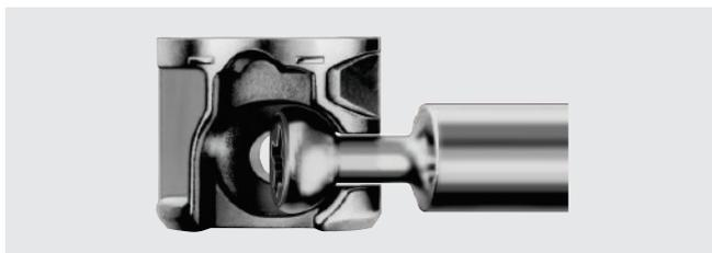
Работа корпусных стяжек системы Minifix® основана на центрическом шаровом принципе. Благодаря этому появилась возможность разработать стяжку, в которой большая поверхность прилегания и затягивания интегрирована в небольшом корпусе стяжки. Полусферическая головка болта абсолютно центрично перемещается и затягивается с геометрическим замыканием в корпусе стяжки Minifix®, представленном в виде сферической чашки.
