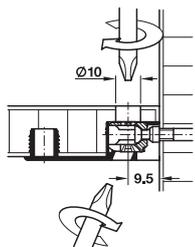
Специальная конструкция корпуса обеспечивает доступ к затягивающему элементу - благодаря этому стяжки могут монтироваться скрытно, например, на нижних полках, и затягиваться через сквозное отверстие 10 мм. После этого сквозное отверстие закрывается заглушкой. Комфортабельное затягивание стяжки производится снизу с помощью отвертки, расположенной под углом 25°
